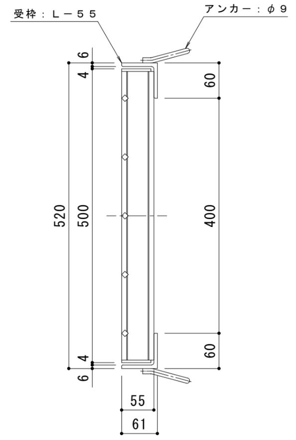
**仕様** ※適用荷重 : T-20 (側溝用)
