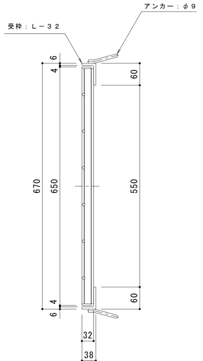
**仕様** ※適用荷重：T-2（側溝用）
