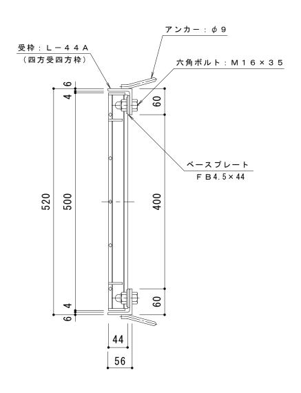
スチール製グレーチング ボルト固定式 枠付正方形型 プレーンタイプ
