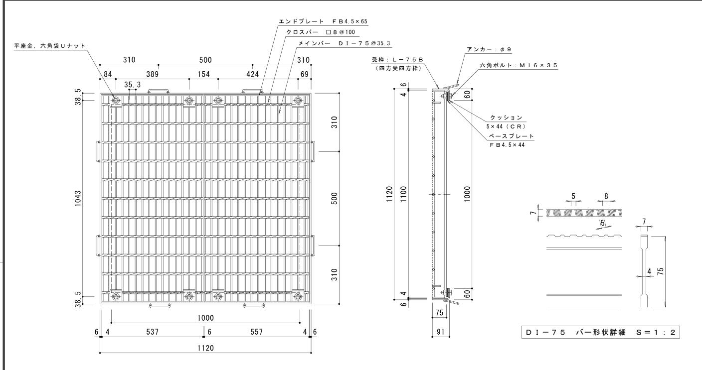
スチール製グレーチング ボルト固定式 枠付正方形型 滑り止め模様付 集水桝用 HXCL 11075
