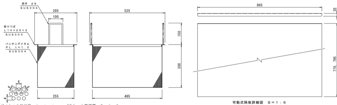
パンチングメタル穴詳細図 S=1:1    バスケット詳細図 S=1:6
