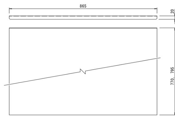
可動式隔板詳細図 S=1:6
