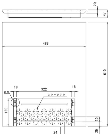
可動式隔板詳細図 S=1:5
