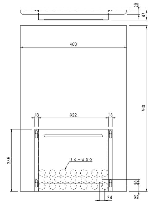
可動式隔板詳細図 S=1:5
