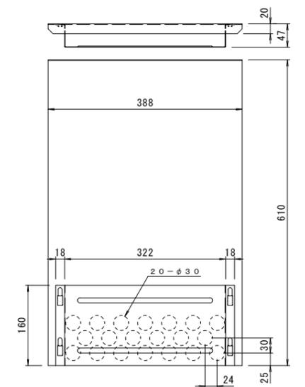
可動式隔板詳細図 S=1:5
