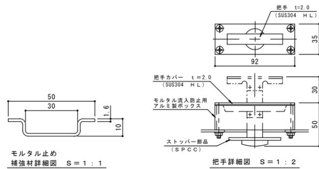
モルタル止め補強材詳細図 S=1:1
