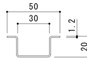
補強材詳細図 S = 1 : 2
