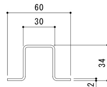
補強材詳細図 S = 1 : 2
