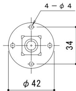
固定プレート平面図 S = 1 : 2
