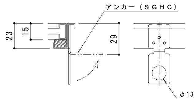
※アンカーは施工時に現場にて折り曲げて下さい
