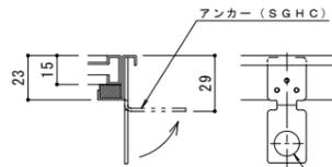
※アンカーは施工時に現場にて折り曲げてください。
