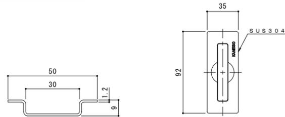
補強材詳細図 S=1:1
