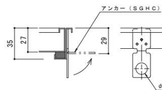
※アンカーは施工時に現場にて折り曲げてください。
