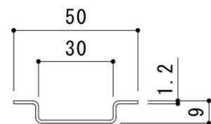
補強材詳細図 S = 1 : 2
