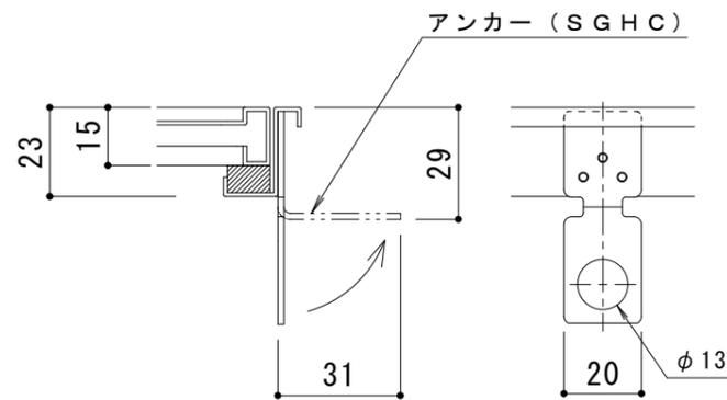
※アンカーは施工時に折り曲げて使用
