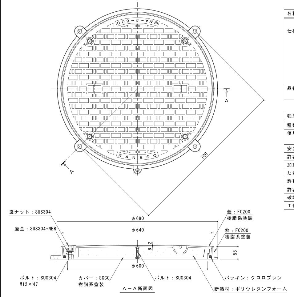
マンホール鉄蓋 蓄熱槽用(断熱形) 密閉形(防水・防臭形) ボルトロック式 角枠 MWA-2D-600(丸)
