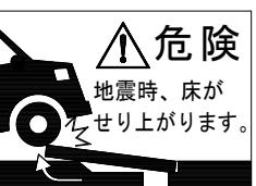
地震時に、免震エキスパンションジョイントの本体パネル上を車両が通過している場合、本体パネルがせり上がり、免震エキスパンションジョイントや車両が、損傷・変形する恐れがあります。
