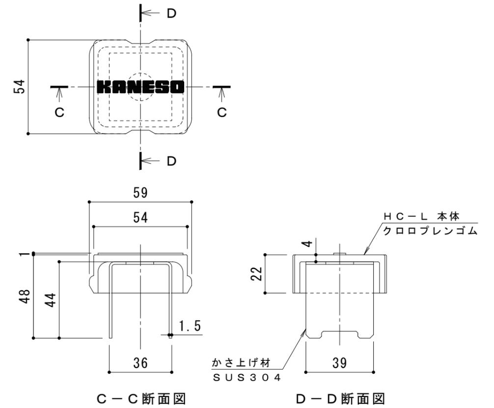
C-C断面図 D-D断面図
