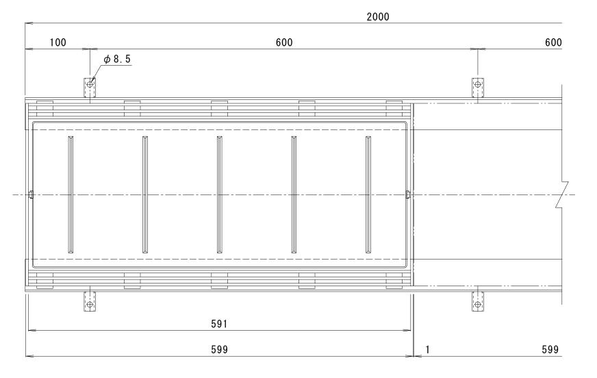
境界部・壁際用として使用できます 回転アンカー: t = 2 . 0 受枠: TL60P, t=3.0 S U S 3 0 4 SECC 30 蓋本体:FC200 樹脂系塗装 290 40 10 クッション: t = 3.0クロロプレンゴム 28 30 က 60 排水ログレーチング(P=10) 66 6.5 S U S 3 0 4
