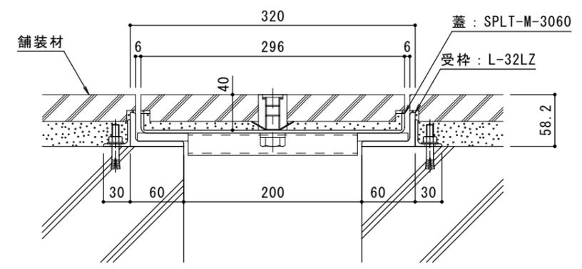
B-B断面図 (納まり図) S = 1 : 4
