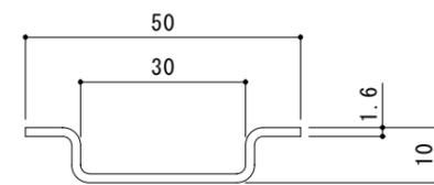
補強材詳細図 S = 1 : 1
