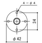
固定プレート平面図 S=1:2
