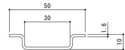
補強材詳細図 S = 1 : 1
