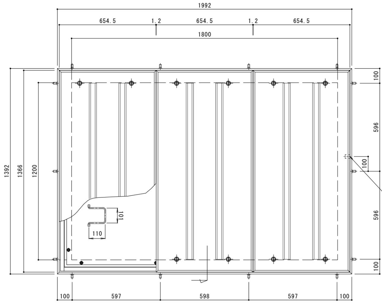
モルタル充填時の蓋重量：≒ 118kg/枚 平面詳細図 S=1:10
