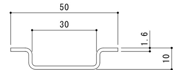
モルタル止め補強材詳細図 S = 1 : 1
