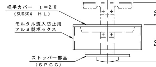
モルタル止め補強材詳細図 S = 1 : 1
