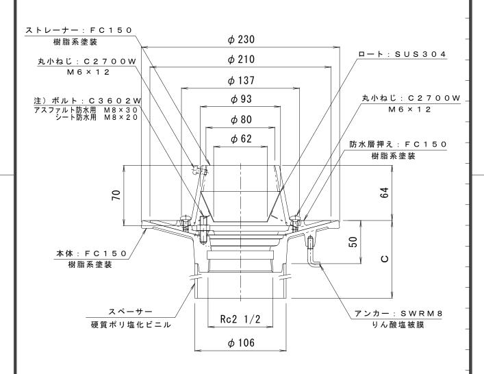
注)ボルト長さの適用防水層の厚さは、次の通りです。 アスファルト防水用の防水層厚さ=10~12mm シート防水用の防水層厚さ=3mm以下 上記以外の場合は、防水層の厚さを御指示下さい。
