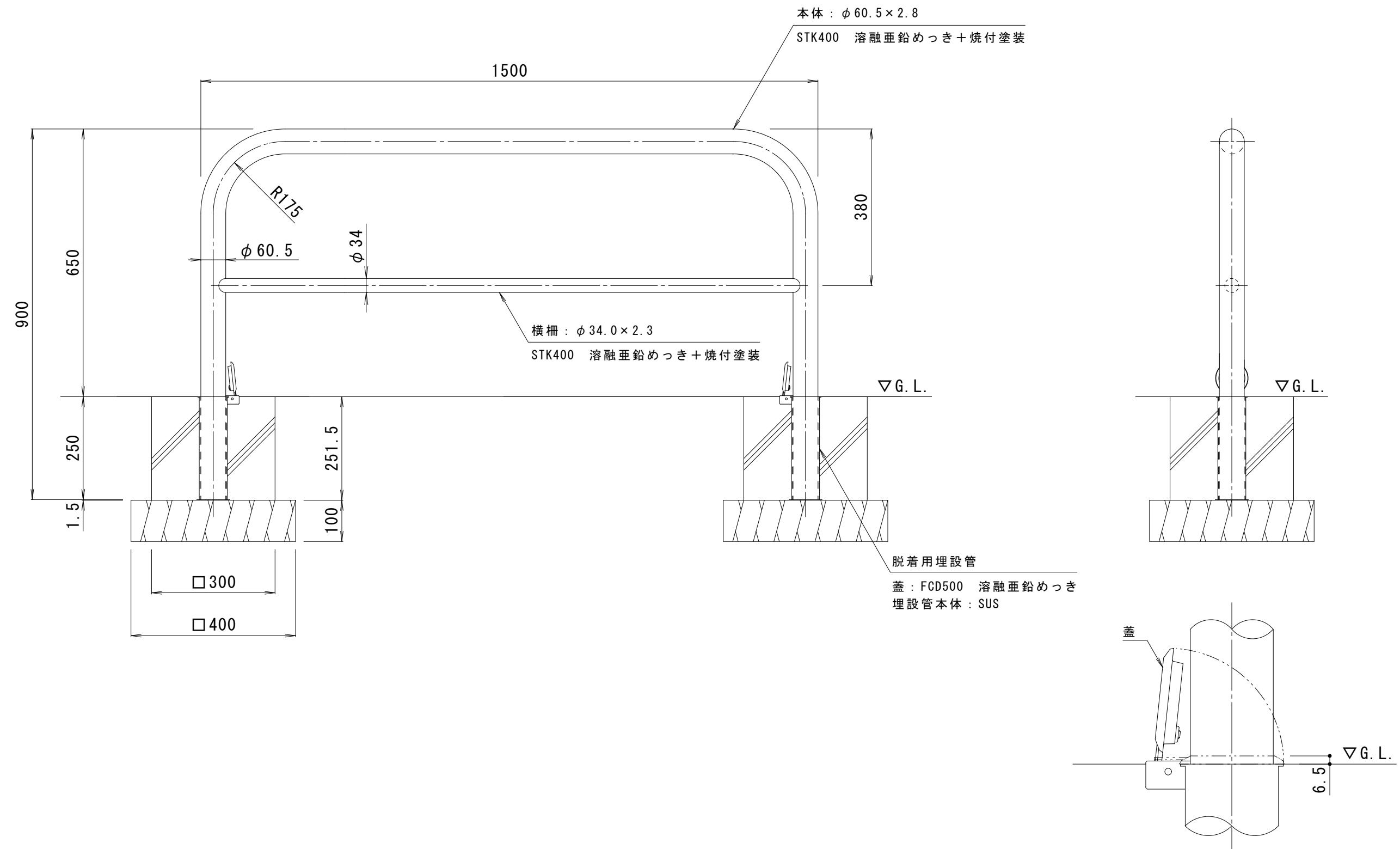
埋設管蓋部詳細図 S = 1 : 3
