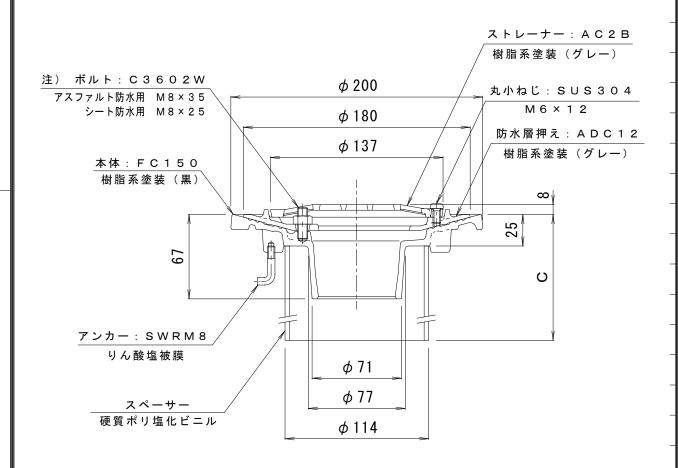
注)ボルト長さの適用防水層の厚さは、次の通りです。 アスファルト防水用の防水層厚さ=10~12mm シート 防水用の防水層厚さ=3mm以下 ※ ご注文の際はC寸法をご指示ください。 上記以外の場合は、防水層の厚さを御指示下さい。
