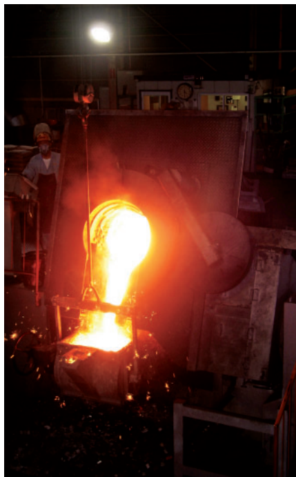
高周波誘導炉〔2.0トン炉〕
