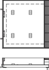
スリット :SS400<br>(溶融亜鉛めっき)<br>蓋、受枠 :SPHC t3.2<br>(溶融亜鉛めっき) | 795         |
