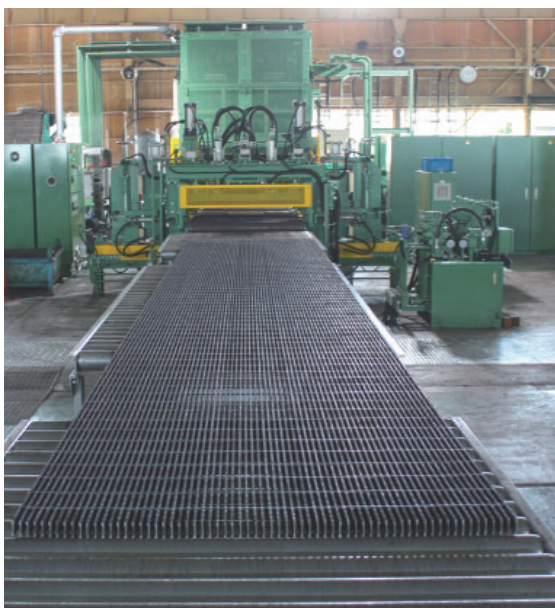
スチール製グレーチング生産設備
